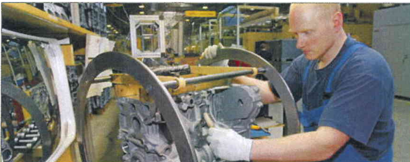
René Helmer (31) kontrolliert die frischen Bohrungen am Zylinderkopf eines künftigen BMW-Motors. Foto: Mario Gentzel
